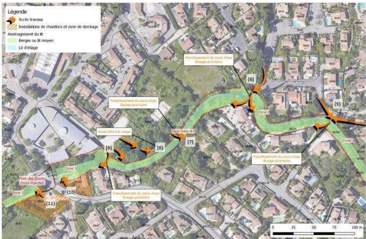
Figure 45 : Accès chantier – Zones 4, inter 4-5 et 5
